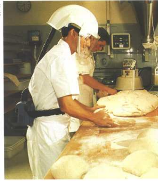
Figure 16 Casque avec amenée d'air frais
